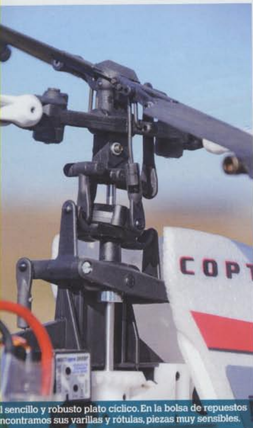
Dos únicos servos controlan al rotor principal. El tercero es para el paso de cola.
