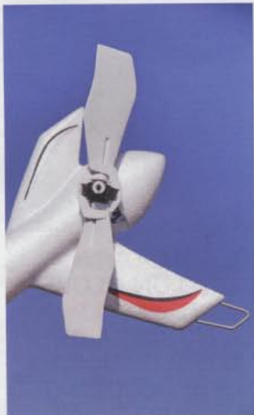
El rotor de cola es un tanto peculiar pero efectivo y resistente. Se mueve por transmisión desde el motor central.
