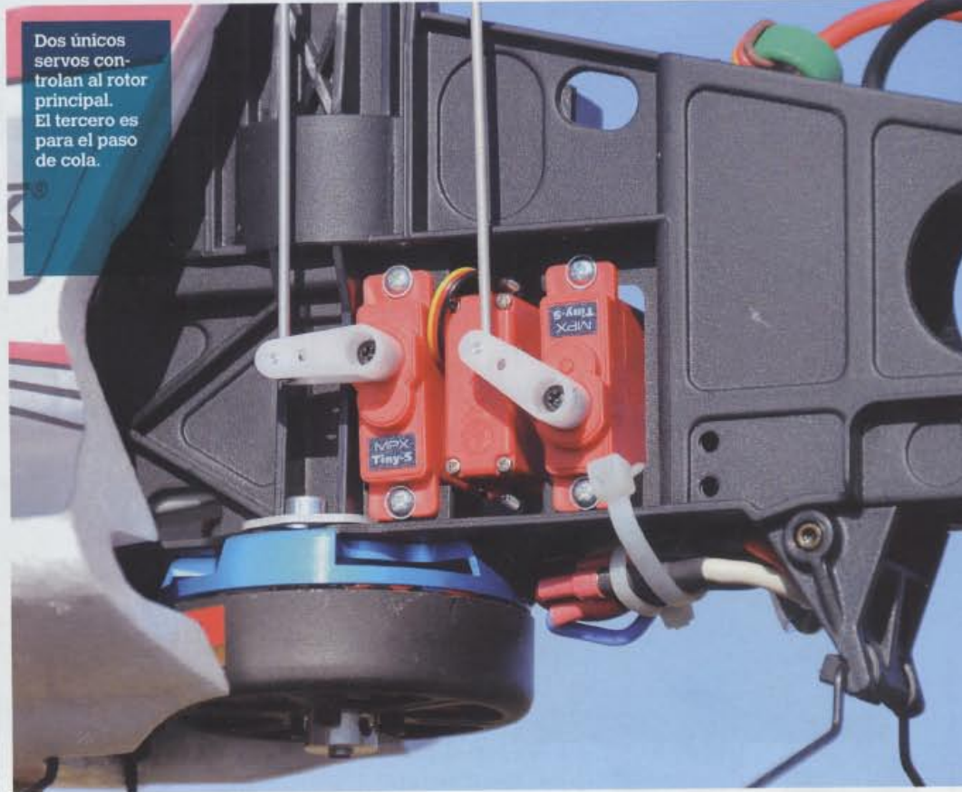
El sencillo y robusto plato cíclico. En la bolsa de repuestos encontramos sus varillas y rótulas, piezas muy sensibles.
